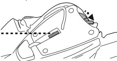
3. Posuňte vypínač do polohy „ON“ ( když je robot stále ponořen ) - rozsvítí se kontrolka a automaticky se aktivuje motor ( hladina vody zakrývající senzory v horní části otočné hlavy ). Nechte robota klesnout na dno bazénu a sledujte jeho první pohyby dopředu a dozadu na dně bazénu. Pokud se pohybuje podél stěny bazénu a ne kolmo, vytáhněte jej a znova ponořte, přičemž se ujistěte, že jeho přední/zadní strana směruje ke stěně bazénu.
