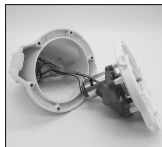
3. Vyjměte baterii, abyste odkryli desku plošných spojů. Chcete-li odpojit připojovací vodič baterie, zatlačte na sponu konektoru a vytáhněte jej. **POZNÁMKA:** Konektor okamžitě obalte izolační páskou, aby nedošlo ke zkratu způsobenému kontaktem obou svorek vodiče.
