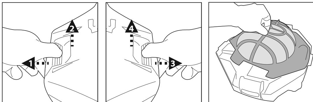
2. Vyndejte kryt filtru a odstraňte nečistoty z prostoru. Doporučujeme vycistit síťku filtru proudem vody. Pokud považujete za nutné síťku kartáčovat, čistěte ji jemně, pouze měkkým kartáčem, a to tak, aby nedošlo k jejímu poškození.
